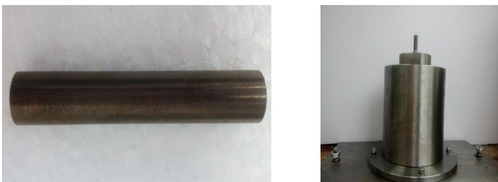
图 超磁致伸缩材料、超磁致伸缩驱动器
