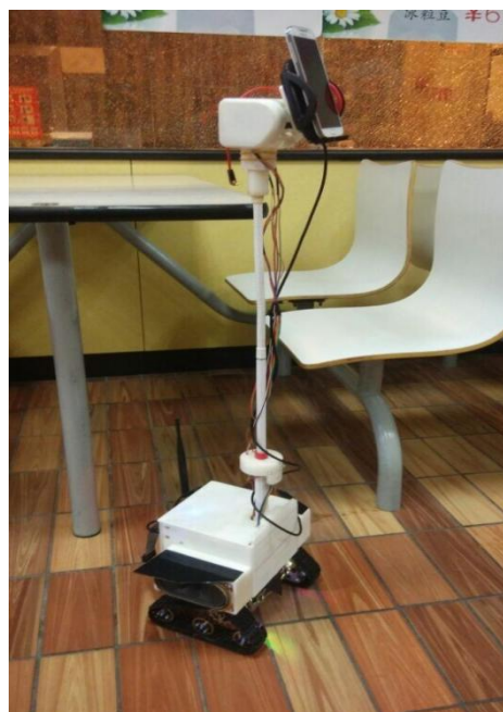
(图2 机器人管家原型机脖颈升高图片)
