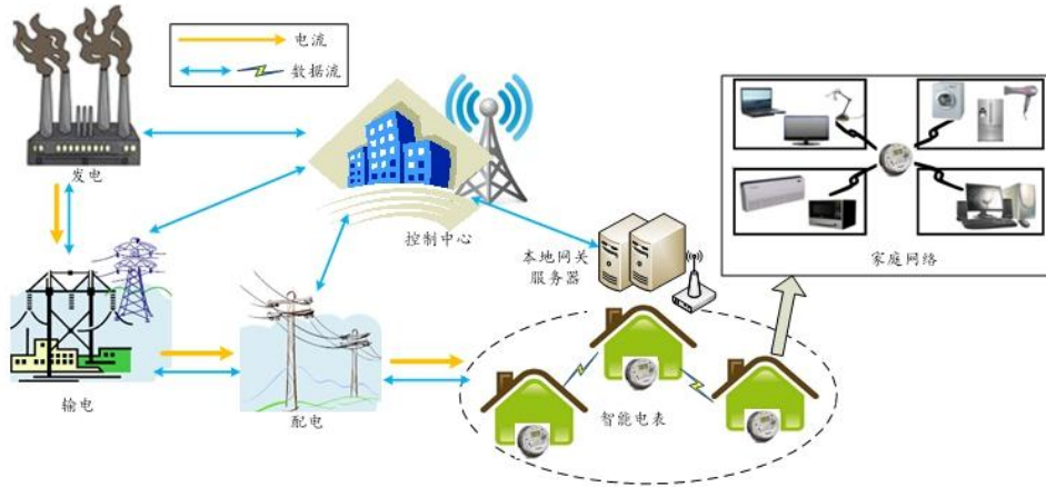
图 1 智能电网的用电数据流通模型
