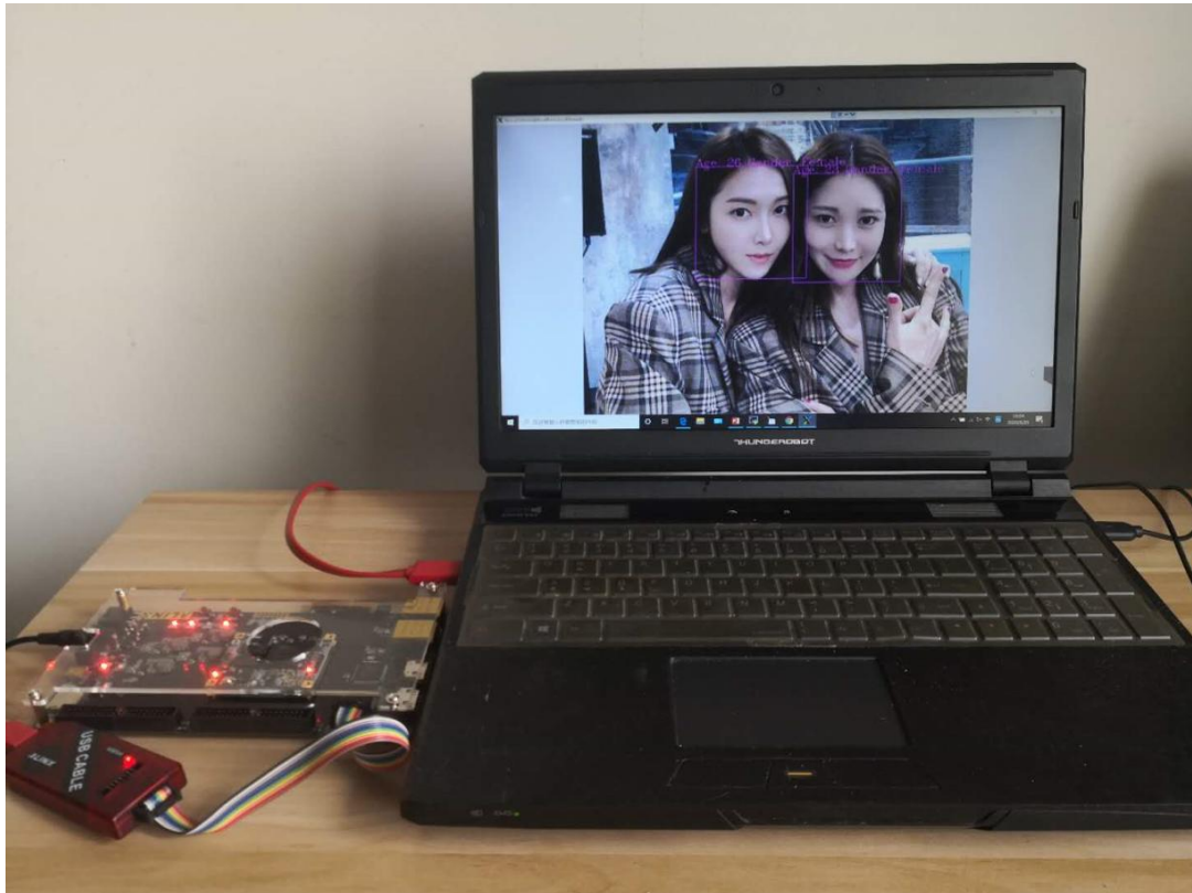
图 2 人脸检测与识别的 FPGA 平台系统
